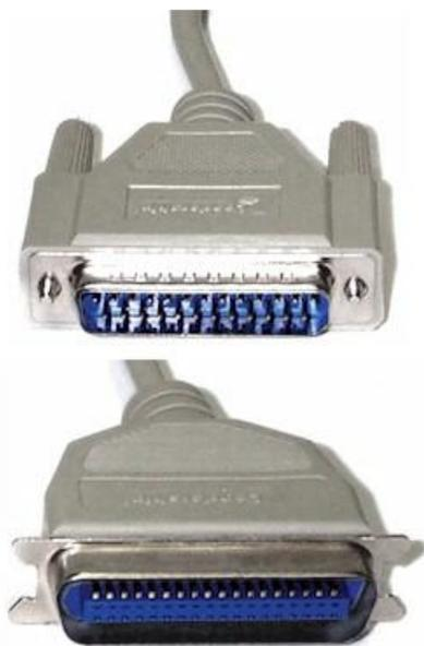
Figura 4 - Terminais do Cabo CENTRONICS (GOOGLE, 2011)
