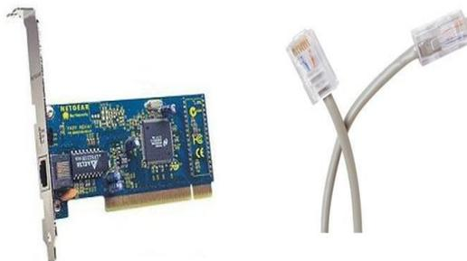
*Ilustração 13: Placa de rede e cabo ethernet*
